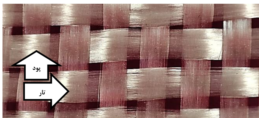
شکل ۱ نمایی از نوع بافت الیاف شیشه مورد استفاده در ساخت گلار
