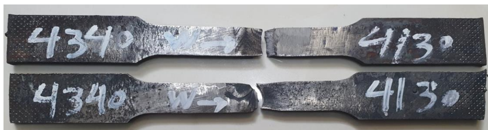
شکل ۷ تصویر نمونه کشش شکسته شده از منطقه HAZ فولاد AISI 4130
