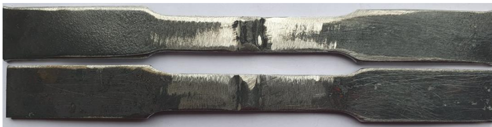
شکل ۲ شماتیک نمونه تست کشش بر اساس استاندارد ASTM E8
