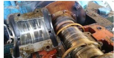
نمونه‌ای از خرابی تکیه‌گاه بر اثر افزایش دما
