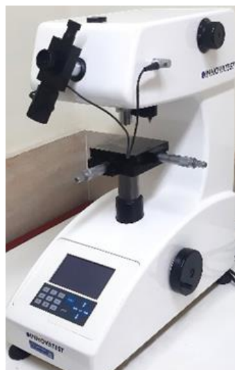
شکل ۴ دستگاه میکروسختی و محل نقاط A، B و C بر سطح عمود بر محور نمونه اکستروژن شده جهت اندازه گیری میکروسختی
