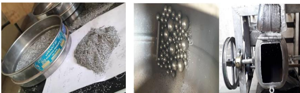
شکل ۱ پودر کردن براده‌های آلومینیومی در دستگاه آسیای گلوله‌ای با اندازه‌های مختلف گلوله
