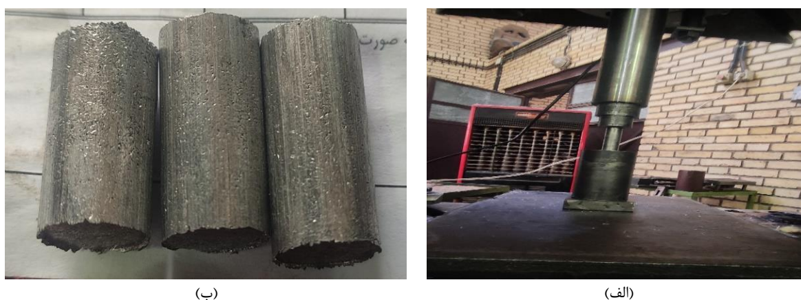
شکل ۲ الف) فشردن پودر در قالب مناسب فشردن و ب) قطعات آلومینیومی خام اولیه فشرده شده سرد
