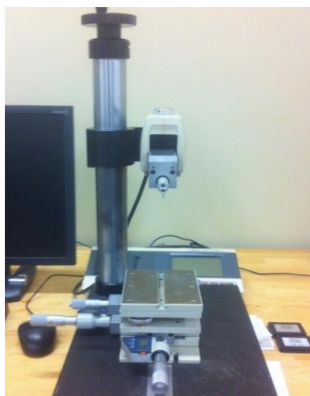
شکل ۲ زبری سنج استفاده شده (Mitutoyo SJ 400)
