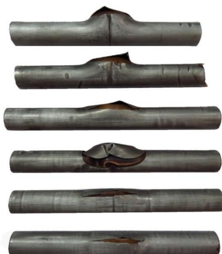
شکل ۴ نمونه لوله‌های دو لایه‌ی آلومینیوم-مس هیدروفرم شده معیوب
