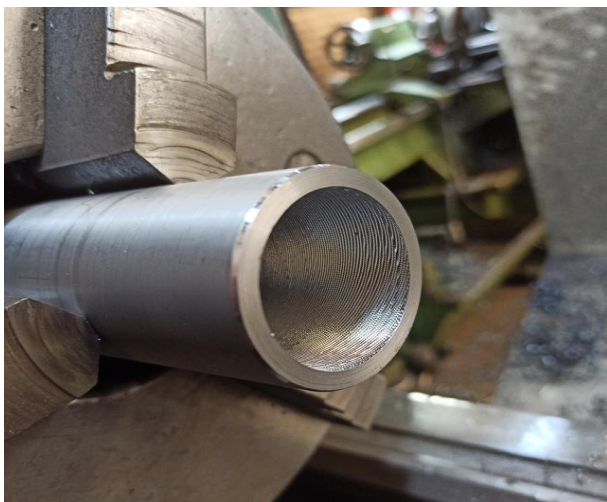
شکل 2 کیفیت پایین سطح قطعه کار به دلیل ارتعاش زیاد ابزار داخل تراش
