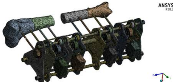
Fig. 2 Meshing to model the motorized unilateral external bone fixator شکل 2 مش بندی برای مدل‌سازی دستگاه ثابت کننده خارجی یک طرفه موتوردار استخوان
