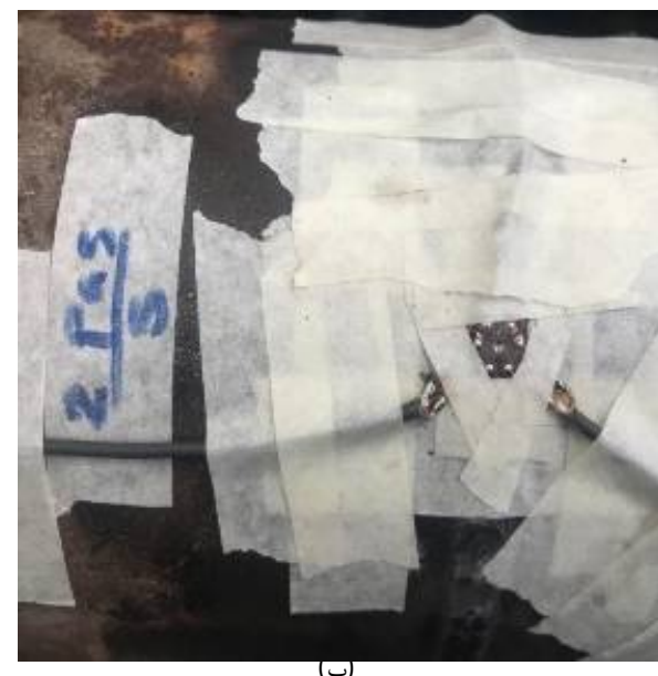
Fig. 4 a) Sample rosette strain gauge installed, b) Rosette strain gauge sample installed after drilling شکل 4 الف) نمونه کرنش سنج رزت نصب شده، ب) نمونه کرنش سنج رزت نصب شده بعد از سوراخ کاری
