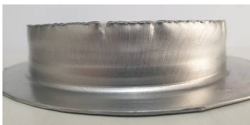
Fig. 9 Longitudinal crack in flange edge
