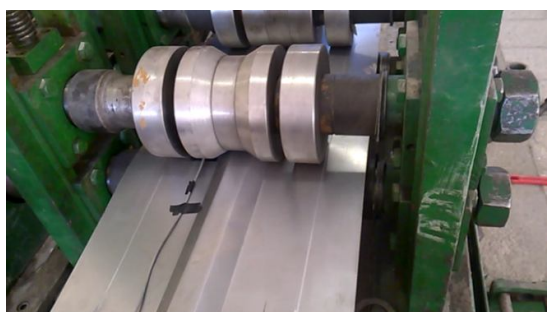
Fig. 9 Experimental roll forming of wide Profile شکل 9 آزمایش تجربی شکل دهی غلتکی سرد ورق با مقطع عریض
