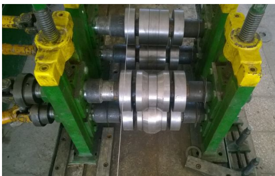
Fig. 8 Experimental roll forming setup شکل 8 تنظیم دستگاه شکل دهی غلتکی برای انجام آزمایش های تجربی
