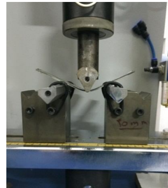
Fig. 3 Three point flexural test of fiber metal laminate specimen شکل 3 نمونه کامپوزیتی الیاف-فلز تحت آزمون خمش سه‌نقطه‌ای
