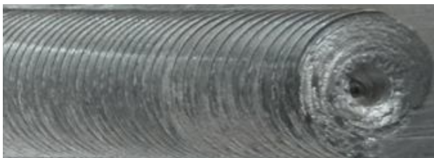
Fig. 13 Surface material flow in joint which welded by 2° tool tilt angle شکل 13 جریان سطحی اتصال در زاویه انحراف 2 درجه
