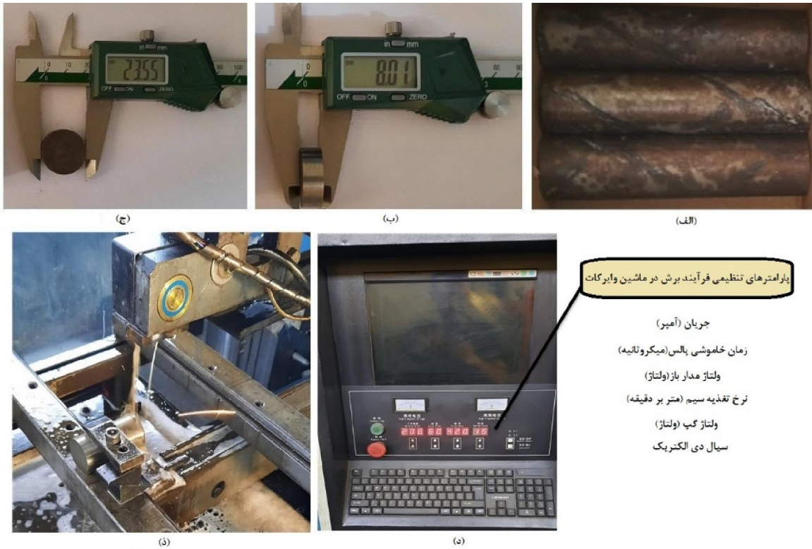
شکل ۲ الف) سه عدد نمونه میلگرد از فولاد آلیاژی M040 پس از فرآیند سخت کاری، ب) ضخامت نهایی قطعه، ج) قطر نهایی قطعه، د) تنظیمات پارامترهای ماشین کاری در ماشین وایرکات و (ذ) نمونه در حال برش
