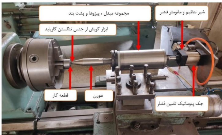
شکل ۵ مدل‌سازی اجزاء و مونتاژ تجهیزات فناوری کوبش فراصوتی
