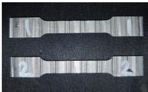
شکل ۴ نمونه‌های آزمون کشش تهیه شده از ورق‌های CGP شده پس از پاس‌های اول و دوم فرآیند
