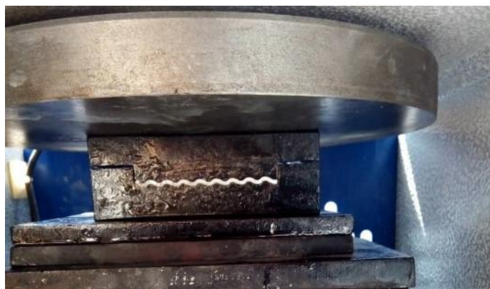
شکل ۲ تغییر شکل ورق در قالب شیاردار
