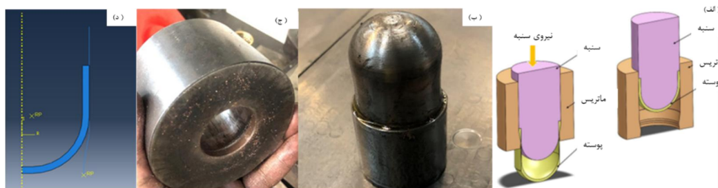
شکل ۱ الف) شماتیک قالب اتوکشی محدود شده، ب) سنبه فرآیند اتوکشی محدود شده، ج) ماتریس فرآیند اتوکشی محدود شده، د) شماتیک قالب اتوکشی در نرم‌افزار آباکوس
