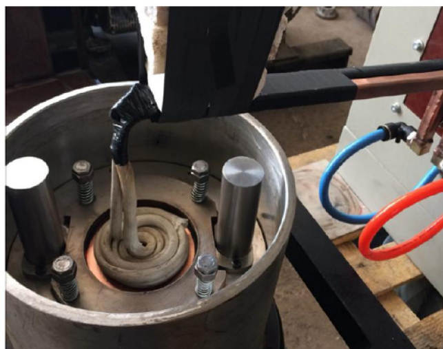
شکل ۶ نمایی از قطعه‌کار در مجموعه قالب و محفظه وکیوم
