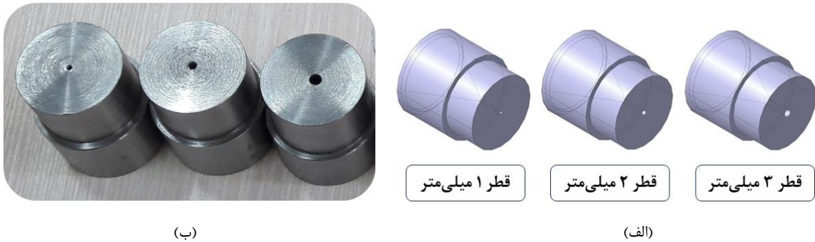
شکل ۱ تصویری از قالب‌های طراحی شده و ساخته شده (الف) قالب‌های طراحی شده با قطرهای متفاوت (ب) قالب‌های ساخته شده با قطرهای متفاوت
