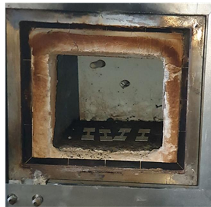
شکل ۶ عملیات آنیل (دو ساعت در دمای ۴۱۵ درجه و خنک شدن در محیط)
