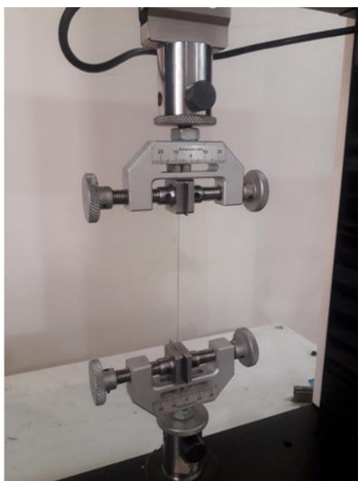
شکل ۶ آموزش کشش سیم تولیدشده روی دستگاه مربوطه
