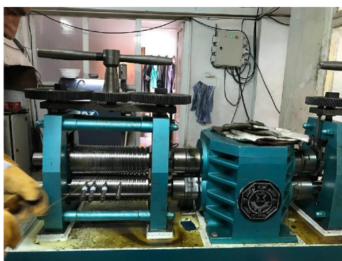
شکل ۳ کاهش قطر سیم توسط دستگاه نورد
