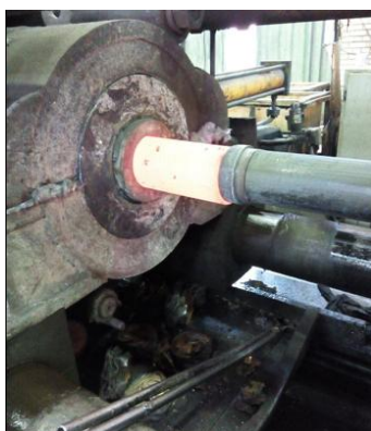
شکل ۲ دستگاه اکستروژن استفاده‌شده در پژوهش کنونی
