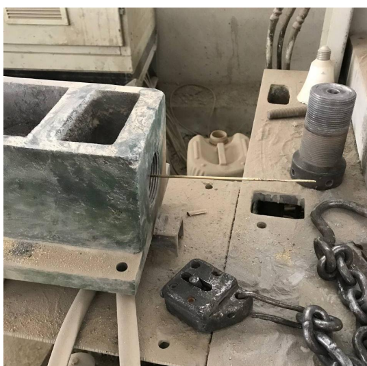
شکل ۵ محل کشش سیم از داخل قالب کشش
