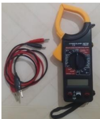
شکل ۴ مولتی‌متر مورد استفاده برای اندازه‌گیری جریان، ولتاژ و مقاومت
