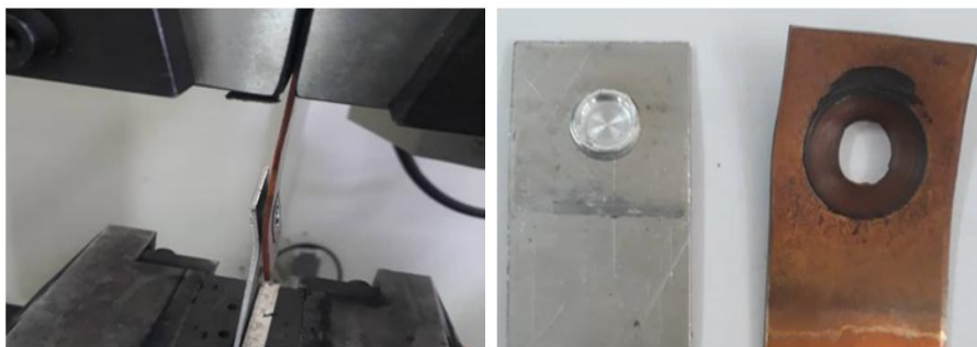
شکل ۶ گسیختگی دکمه جوش بعد از کشیدگی زیاد دکمه جوش و جذب بالای انرژی شکست
