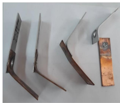
شکل ۱۱ نمونه‌های تست خمش شده حالات مختلف قرارگیری ورق‌های مس و آلومینیوم
