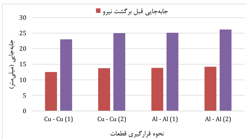
شکل ۹ نمودارهای تغییرات جابجایی در حالت‌های قرارگیری مختلف قطعات در نمونه‌های همجنس
