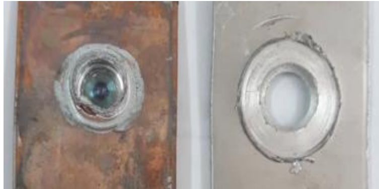
شکل ۷ گسیختگی برشی جوش از محل فصل مشترک دو ورق
