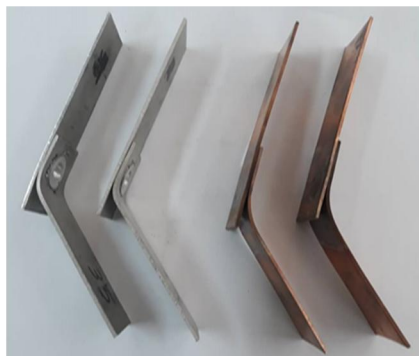
شکل ۱۱ نمونه‌های تست خمش شده حالات مختلف قرارگیری ورق‌های مس و آلومینیوم
