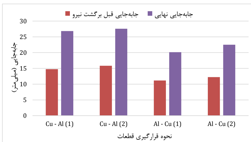
شکل ۱۰ نمودارهای تغییرات جابجایی در حالت‌های قرارگیری مختلف قطعات در نمونه‌های غیر همجنس
