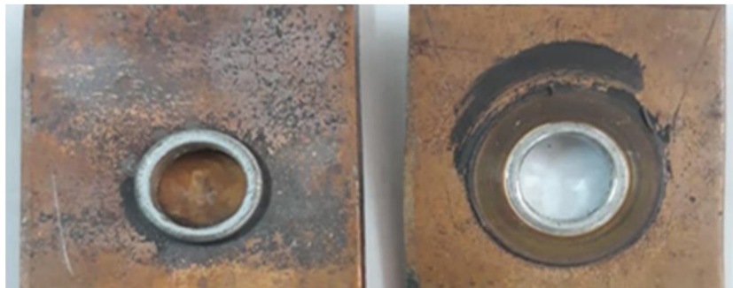
شکل ۸ گسیختگی سطحی جوش از محل دایره محاط بر دکمه جوش
