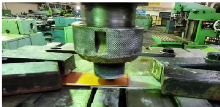
شکل ۴ فیکسچر و روبنده‌های نگهدارنده قطعات جوشکاری
