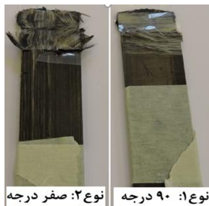
شکل ۱۲ سطح شکست جوش نمونه کامپوزیتی بعد از آزمایش کشش
