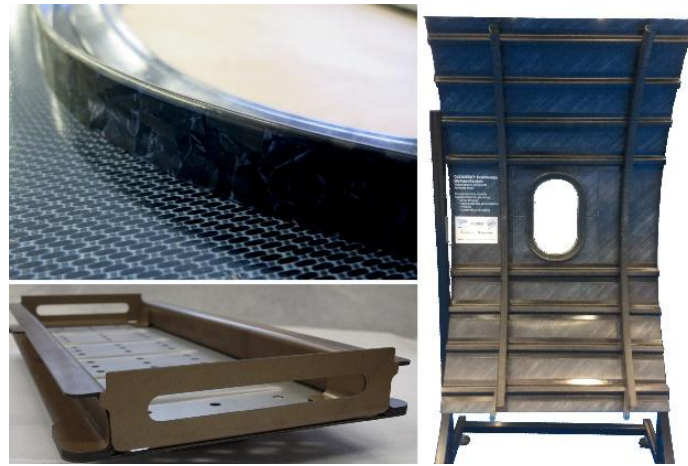
شکل ۱ استفاده از جوش آلتراسونیک در اتصال کامپوزیت گرمانرم در بدنه هواپیما [۱۱]
