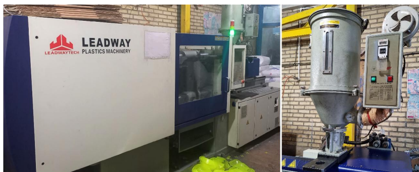
شکل ۱۲ دستگاه تزریق پلاستیک FUHRUNG Ningbo Leadway مدل Blaze 1800-II و کیفی خشک کن دستگاه
