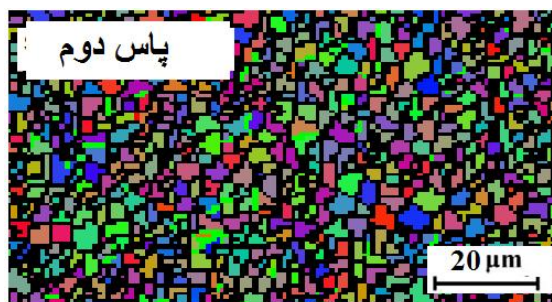
شکل ۶ ریزساختار شبیه‌سازی شده منیزیم توسط مدل اتومات سلولی در الف) حالت اولیه ریخته‌گری شده، ب) در انتهای سیکل اول و ج) در انتهای سیکل دوم فرایند
