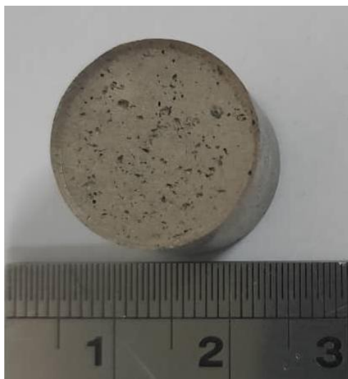
شکل ۱ نمونه منیزیمی با تخلخل ۲۴٪ ساخته شده از پودر 63 \mu\text{m} بعد از دو مرحله زینتر
