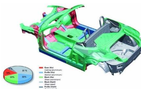
شکل ۱ مواد به کار رفته در بدنه یک خودروی مدرن [۲]
