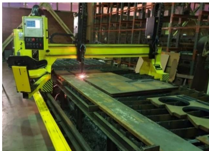
شکل ۳ برشکاری ورق‌ها به وسیله دستگاه هوا برش CNC
