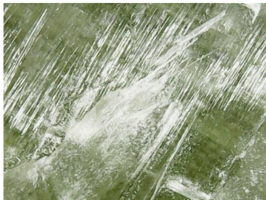
شکل ۷ تصویر سطح ماشینکاری شده قطعه با زاویه الیاف ۴۵ درجه
