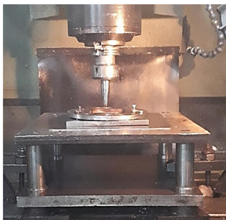
شکل ۲ تجهیزات انجام آزمون‌های شکل‌دهی تدریجی ورق
