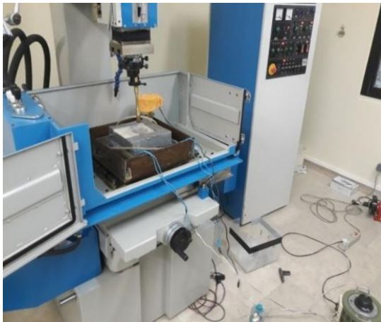
Fig. 1 Applying the magnetic field along with installing the fixture شکل ۱ اعمال میدان مغناطیسی به همراه نصب فیکسچر
