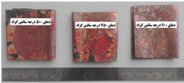
Fig. 1 Annealed copper sheets at different temperatures – thickness 0.3 mm شکل ۱ ورق‌های مسی آنیل شده در دماهای مختلف- ضخامت ۰٫۳ میلی‌متر
