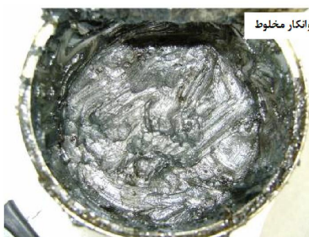
Fig. 3 Images of the lubricants used for ECAP processing of CP-Ti شکل ۳ تصاویری از روان‌کارهای استفاده شده برای فرآوری تیتانیوم خالص تجاری
