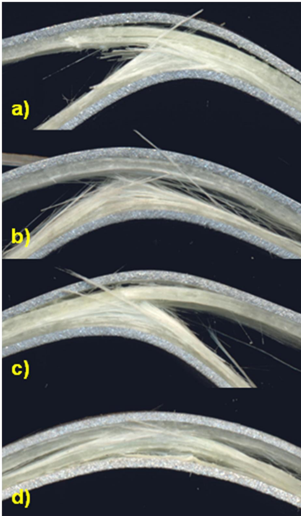
Fig. 9 The microstructural image from FMLs with the 0^{\circ}/0^{\circ}/0^{\circ} configuration under the various thermal cycling; a) 0, b) 10, c) 50, d) 90 0^{\circ}/0^{\circ}/0^{\circ} شکل ۹ تصویر میکروساختاری چند لایه الیاف- فلز با چیدمان 0^{\circ}/0^{\circ}/0^{\circ} تحت سیکل‌های حرارتی متفاوت: (a) 0, (b) 10, (c) 50, (d) 90
