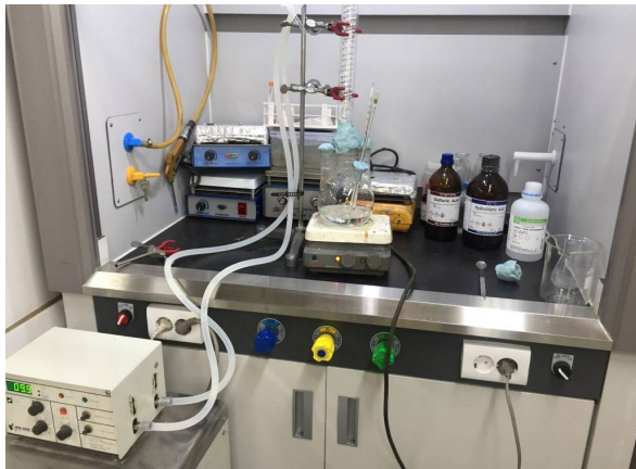
Fig. 2 Solvent de-binding reactor setup with condenser. شکل 2 تجهیزات و امکانات راکتور بایندرزدایی حلالی به همراه کندانسور.
