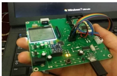
Fig. 2 Complete assembly of remote coordinate navigation module شکل 2 مونتاژ کامل دستگاه ناوبری مختصات یاب از راه دور
