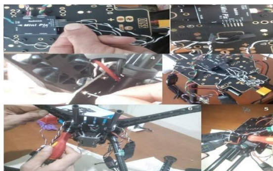
Fig. 10 Installing speed control signal cables and airframe plugs شکل 10 نصب کابل‌های سیگنال اسپید کنترل و شاخک‌های ایرفریم
