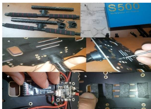
Fig. 7 Installing airframe bases with the receiver and power module شکل 7 نصب پایه‌های ایرفریم هم‌زمان با گیرنده و ماژول پاور
