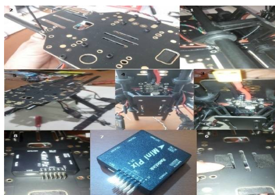
Fig. 9 Installing flight control on airframe main plane شکل 9 نصب فلایت کنترل روی صفحه اصلی ایرفریم
