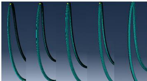
Fig. 5 Mesh size (respectively from left: 0.04 / 0.06 / 0.08 / 0.1 / 0.12) شکل 5 اندازه مش (به ترتیب از چپ 0/12-0/1-0/08-0/06-0/04)
