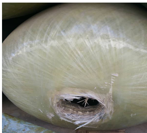
شکل 8 ناحیه شکست مخزن با ضخامت ثابت تحت آزمون فشار ترکیدگی Fig. 8 Tank failure area under bursting pressure test
