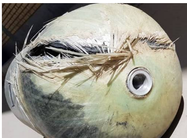
شکل 11 ناحیه شکست مخزن با ضخامت متغیر تحت آزمون فشار ترکیدگی Fig. 11 Failure area of the tank with variable thickness under bursting pressure test
