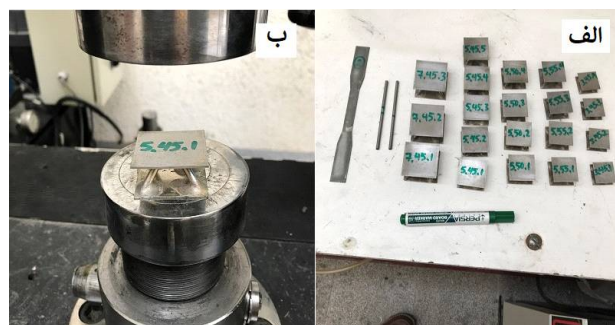
Fig. 10 a) Fabricated specimens b) compression test of specimen شکل 10 الف) تعداد نمونه‌های ساخته شده ب) آزمون فشار نمونه‌ها
