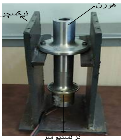
شکل 3 تصویر مجموعه‌ی پایه‌ی نگهدارنده به همراه هورن و ترانسدیوسر Fig. 3 Experimental setup with horn and transducer
