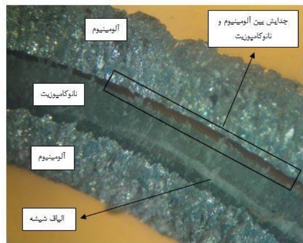
شکل 7 تصویر میکروسکوپ نوری از مقطع نمونه آزمون خمش سه‌نقطه‌ای Fig. 7 Optical microscope image of the cross section of a three-point bending test specimen
