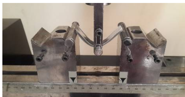
شکل 2 آزمون خمش سه‌نقطه Fig. 2 Three-point flexural test
