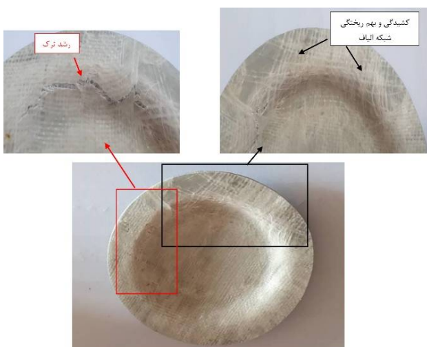
شکل 11 آسیب لایه نانوکامپوزیتی میانی پس از تغییر شکل کل ورق
