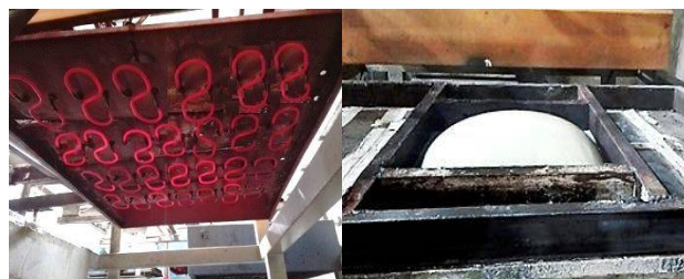
Fig. 3 Primary bubble and heater of the sheet for vacuum forming شکل 3 هیتر حرارت دهی و حباب اولیه ورق جهت کیوم فرمینگ
