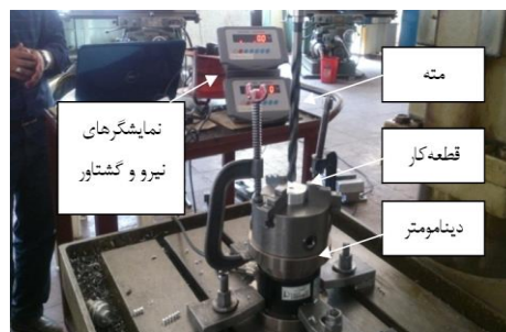
شکل ۲ بستر آزمایش برای اندازه‌گیری نیروی محوری و گشتاور برشی
