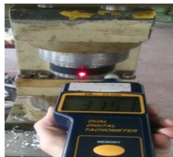
شکل ۱ اندازه‌گیری دور نامی محور دستگاه
