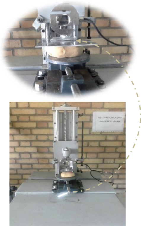
Figure 4 Biological material test device fabricated by Ghaebi et al [19] شکل 4 دستگاه آزمون مواد بیولوژیکی ساخته‌شده توسط غایبی و همکاران [19]
