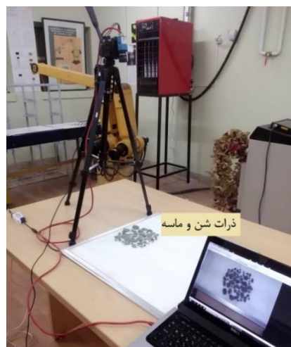
Fig. 9 Imaging of sands using the established laboratory system شکل 9 سیستم آزمایشگاهی در حال تصویربرداری از ذرات شن و ماسه
