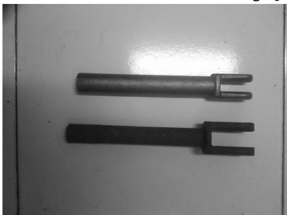
Fig. 17.c Optimization and 25% weight loss for rod clevis شکل 17- پ قطعه کلویس دنباله‌دار بهینه شده و کاهش وزن 25% نسبت به مدل قبلی
