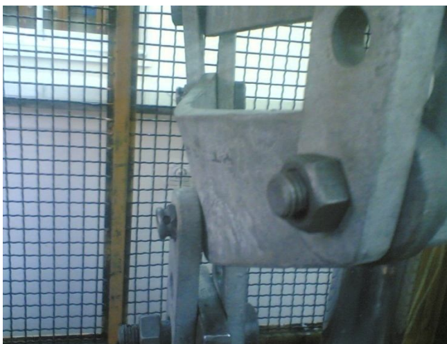
Fig. 22 The lateral buckling of yoke plate in experimental test شکل 22 تغییر شکل یوک مثلثی در آزمایش تجربی از نمای کناری
