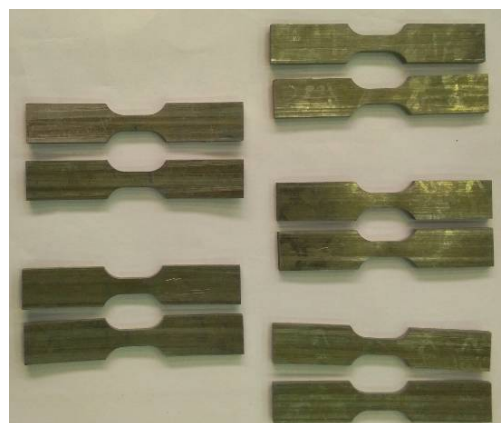
شکل 3 نمونه‌های آماده شده جهت آزمون کشش تک محوره
