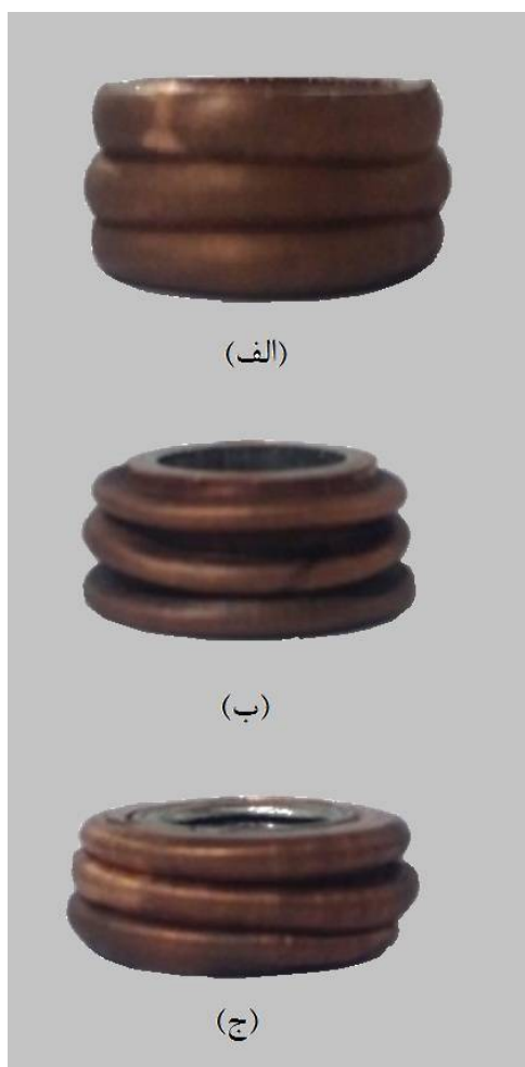
Fig. 9 Crushing of extruded specimens, a) aluminum and copper of both grooves, b) aluminum grooved sample, c) sample without groove شکل 9 لهیدگی نمونه‌های اکستروژن شده در یکدیگر، الف- آلومینیوم-مس هر دو شیار دار، ب- نمونه آلومینیوم شیار دار، ج- نمونه بدون شیار
